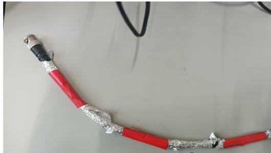
FIGURE 1.12 – Câble coaxial recouvert de feuilles d’aluminium, maintenues au câble à l’aide de scotch.
