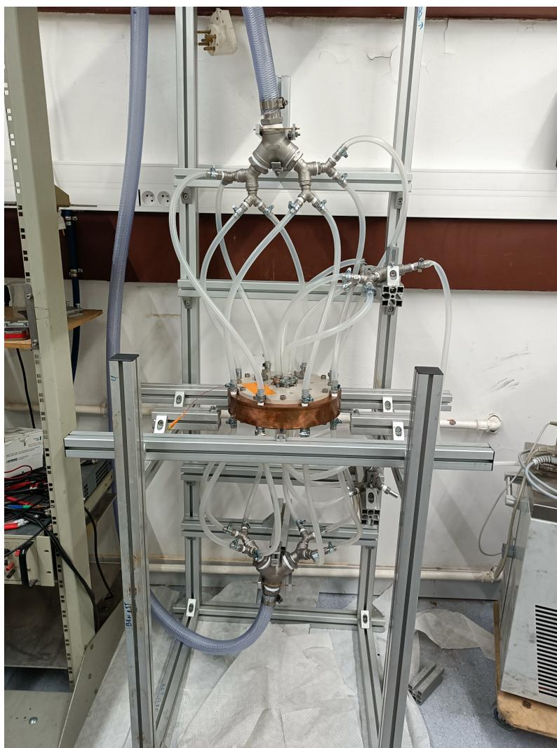
FIGURE 5.3 – Photographie du montage GALLIMERT pour les tests en eau à l'extérieur des bobines de Helmholtz.
