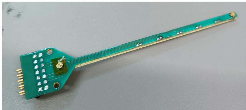
FIGURE 5.4 – Photographie du montage des Pt100 sur le circuit imprimé, vissé sur la fixation en cuivre, l'ensemble ne devant pas faire plus de 5 mm de diamètre. L'extrémité en forme de pelle correspondait aux branchements et était à l'extérieur des cylindres.
