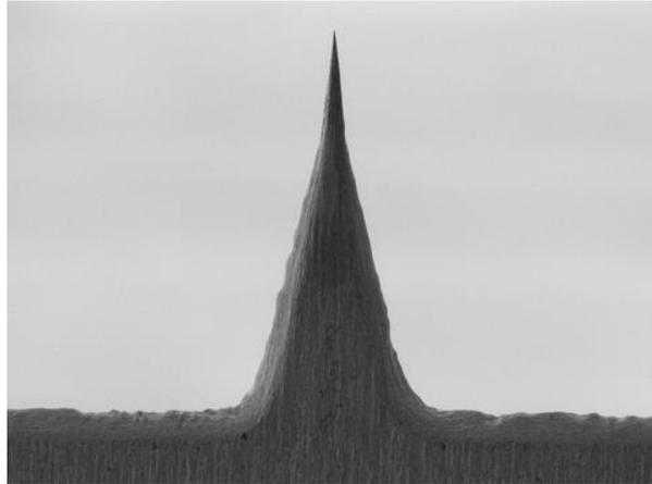
Figure 55 : Grille spécifique en tungstène pour la corrélation MET-SAT avec pré-pointe électropoliée
