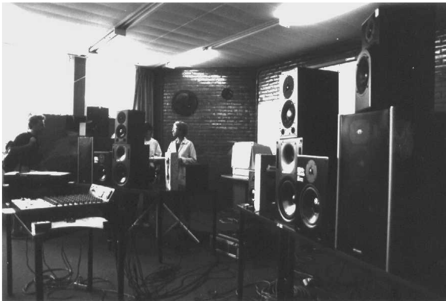
Figure 3-4 : configuration du test de systèmes de reproduction (haut-parleurs + amplificateurs).
