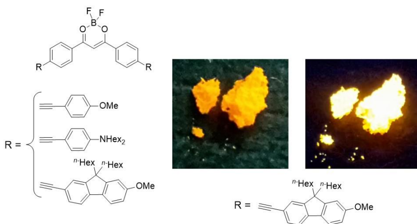
Figure 6 : Structures des composés étudiés et photographie sous lumière naturelle (gauche) et UV (droite) du composé ayant 65% de rendement quantique d'émission à l'état solide.
