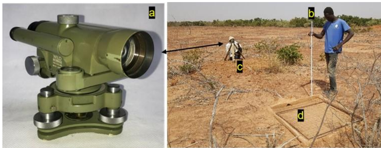
Figure 33. Les outils utilisés pour les mesures de la microtopographie (a, b & c) et des états de surface (d).
