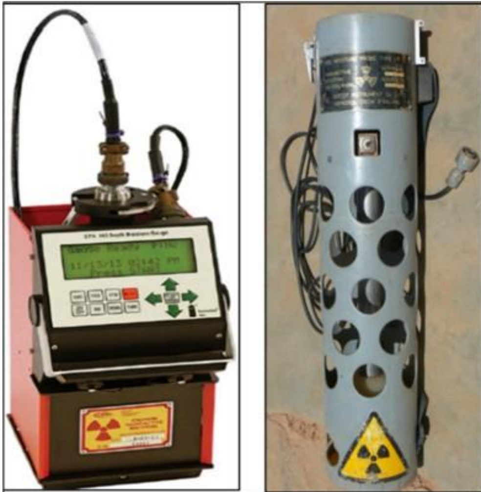
Figure 37. L'illustration de deux modèles de la sonde à neutrons utilisés sur le terrain.
