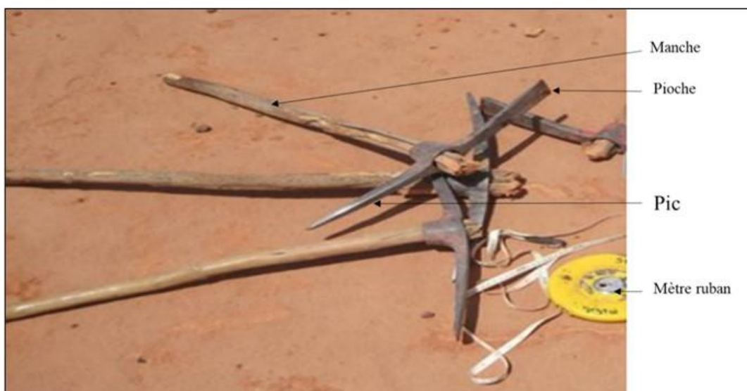
Figure 19. Les outils de réalisation du sous-solage.
