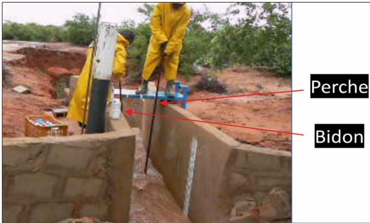
Figure 32. L'illustration de la méthode de prélèvement des échantillons d'eau pour la mesure des matières en suspension (MES) à la station de jaugeage du bassin versant TK-IBM.
