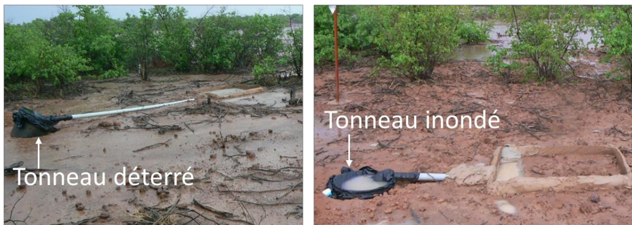
Figure 51. La perturbation du fonctionnement des parcelles de ruissellement causée par la pluie du 17 juillet 2016.
