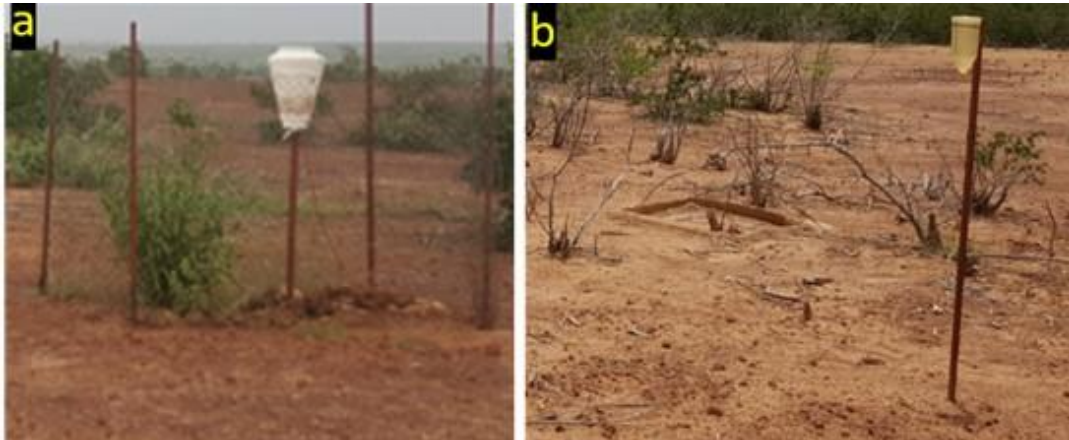
Figure 31. Les outils de mesure de la pluie : pluviographe, à gauche (a) et pluviomètre à lecture directe, à droite (b) installés sur le site d'étude.
