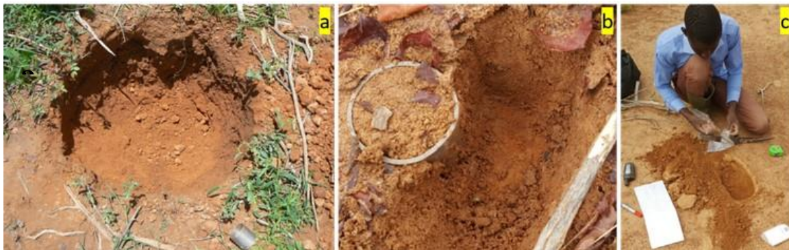
Figure 35. Les outils de mesure de l'humidité du sol. À droite (c), le prélèvement d'un échantillon avec l'utilisation d'une truelle, d'une pioche, d'un GPS, d'un mètre ruban, d'un sachet plastique, d'un becher et d'un marqueur. Au milieu (b), un cylindre enfoncé dans le sol. À gauche (a), un trou de 50 cm qui a servi de prélèvement d'échantillon à chaque 10 cm.
