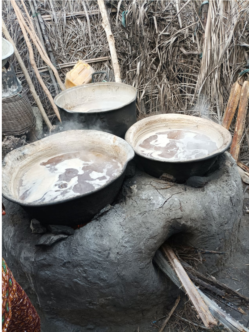
Figure 15 : Four traditionnel permettant la production de sel par évaporation au Bénin. Mars 2022. Crédit : Lisa Macera & Elina Delord.
