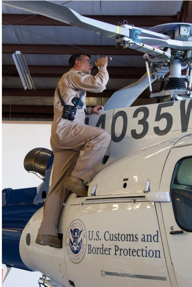
Figure 32: Inspection avant vol du rotor d'un hélicoptère type H125.
