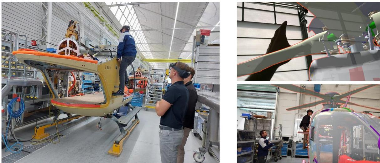
Figure 34: Configuration de deux casques de réalité augmentée, l'un pour le participant réalisant la tâche et l'autre pour l'observateur.
