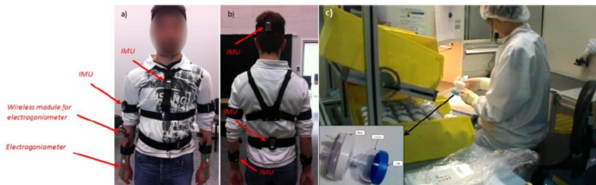
Figure 39: Localisation des centrales inertielles sur le corps et descriptif du poste de travail appelé « nettoyage des filtres ».
