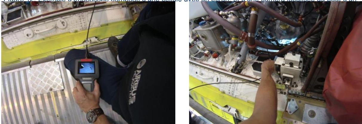
Figure 13: Exemple d'usage d'un endoscope pour réaliser une inspection sur un hélicoptère.
