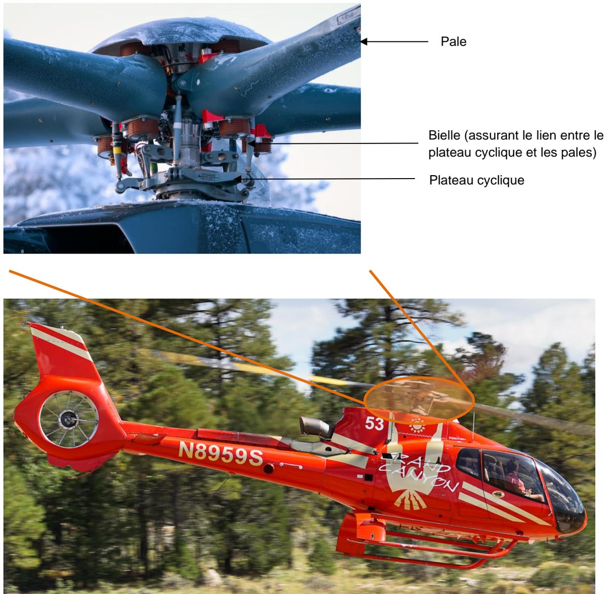
Figure 14: Hélicoptère H130 avec un exemple de tête rotor montrant la pièce à vérifier, appelée « plateau cyclique ».
