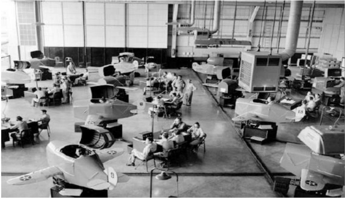
*Figure 26: Link Trainer exploité par l'US Air Force, au Texas, pour la formation des pilotes.*
