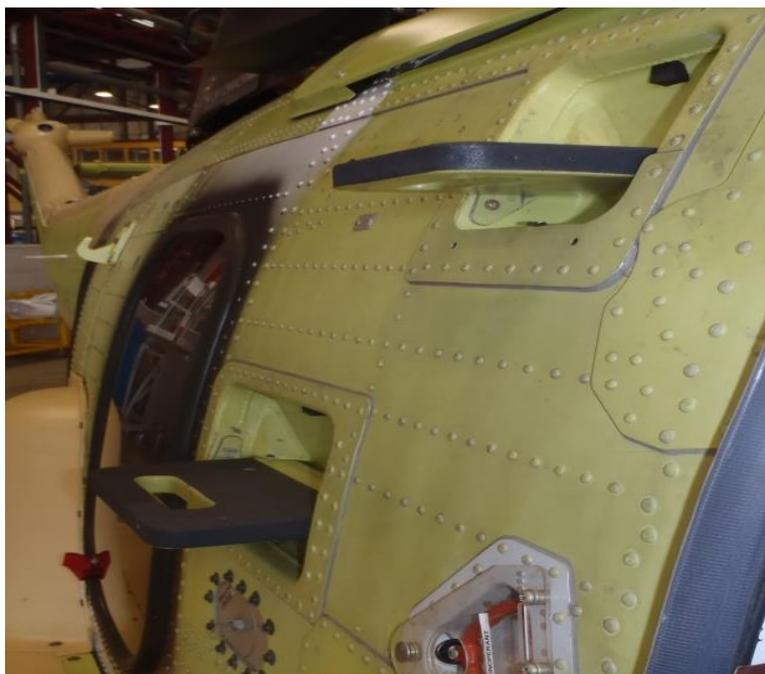
Figure 31: Marchepied pliable sur le fuselage d'un hélicoptère.
