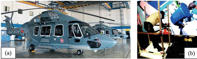
Figure 2. Exemple d'outils de simulation : (a) une maquette physique à échelle 1, (b) une plateforme de réalité virtuelle.
