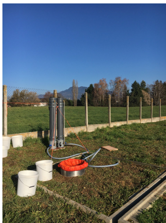
FIGURE 4.9 – Infiltromètre à simple anneau de grand diamètre
