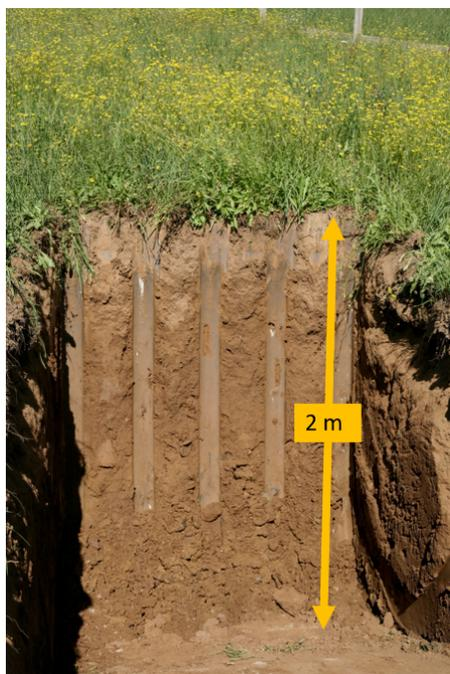
FIGURE 4.1 – Profil de sol à l'emplacement des lysimètres - juillet 2019 [crédit photo : Richard Poncet]
