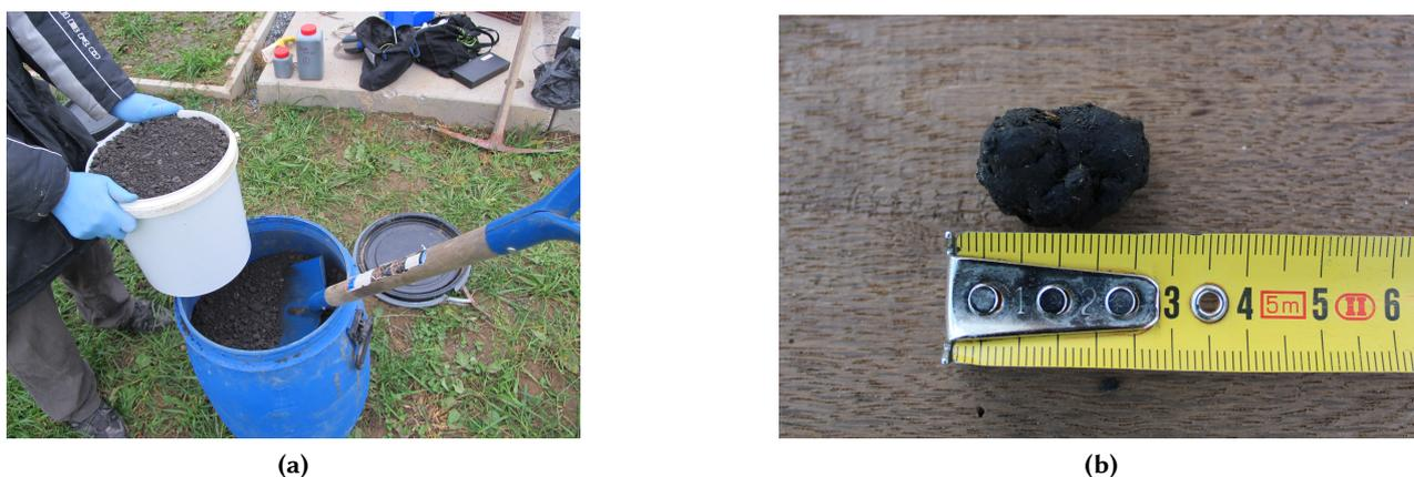
FIGURE 4.19 – (a) Boues épandues sur les lysimètres et (b) Taille d'un agrégat
