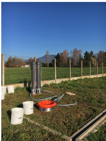
**FIGURE 4.9** – Infiltromètre à simple anneau de grand diamètre
