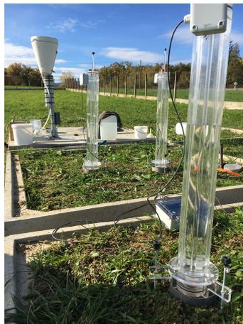
FIGURE 4.8 – Infiltromètre à simple anneau automatisé
