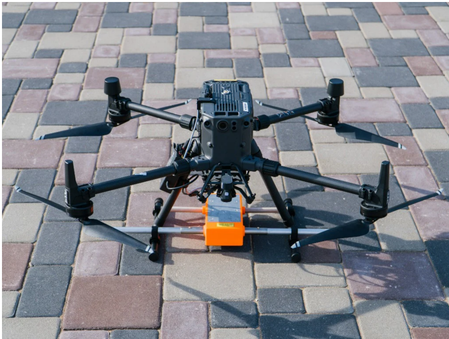
FIGURE 20 – Photographie du nouveau drone DJI M300 RTK embarquant un radar RADSYS Zond Aero Low Frequency disponible à ENDSUM Rouen (crédits photo UGCS).
