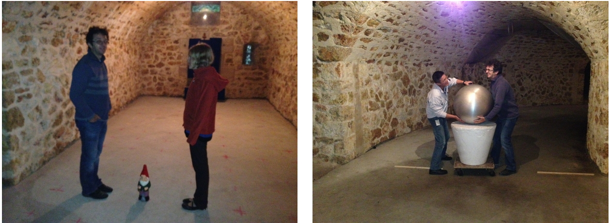
FIGURE 4.4 – Différents types de cibles considérées pour les mesures "caponière" : humains de SER différentes, nain de jardin, sphère métallique.
