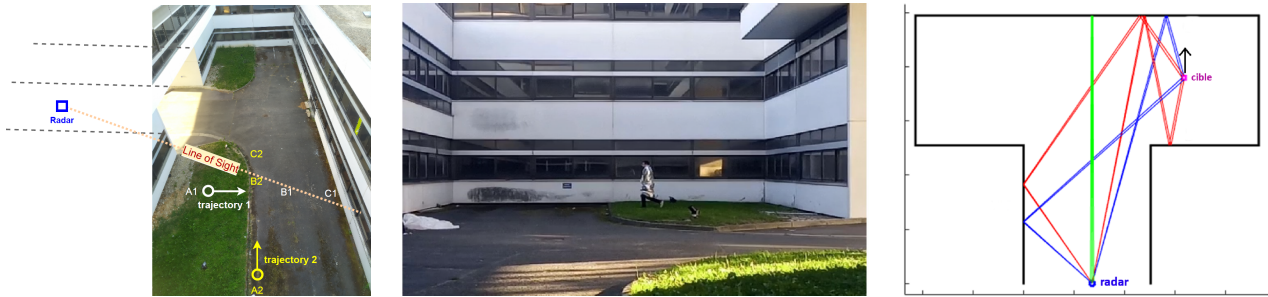
FIGURE 4.7 – Configuration des mesures effectuées lors des thèses de Hung et de Huy. A gauche : un carrefour urbain présentant une zone NLOS. Au milieu : un candidat à l’HDR emballé dans une couverture de survie pour mieux servir de cible. A droite : modèle géométrique de la scène et exemple de lancer de rayons.
