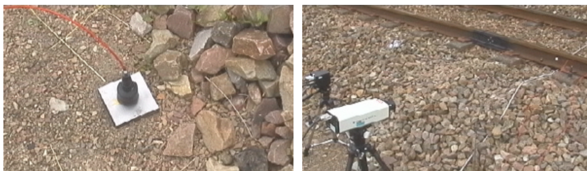
Figure 91 - Mesures accélérométriques à la surface du sol (à gauche), vélocimétrie Laser (à droite)
