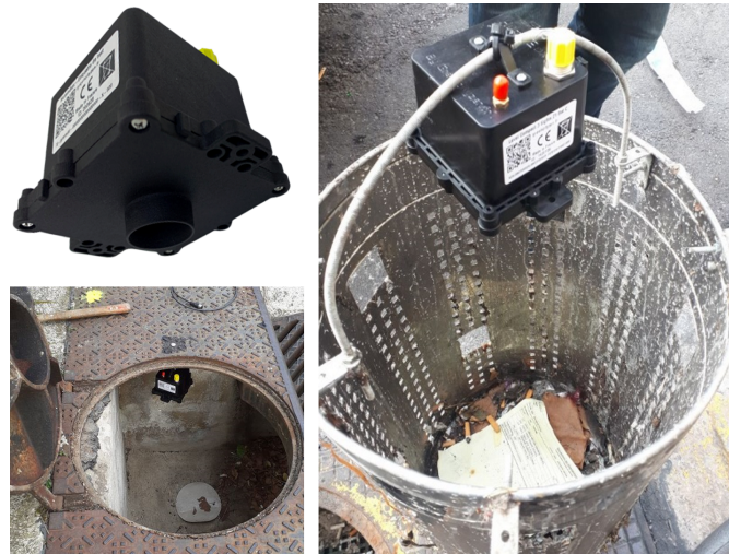
FIGURE 1.9 – Capteur utilisé pour mesurer le niveau d'encrassement d'un avaloir.
