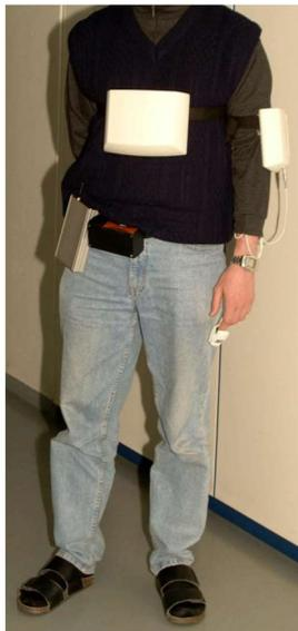
Figure 15 : a) dispositif Healthware en place sur un volontaire avec le saturomètre au bras gauche, l'ECG sur le torse, la PBS avec l'accéléromètre à la ceinture et b) schéma de communication .
