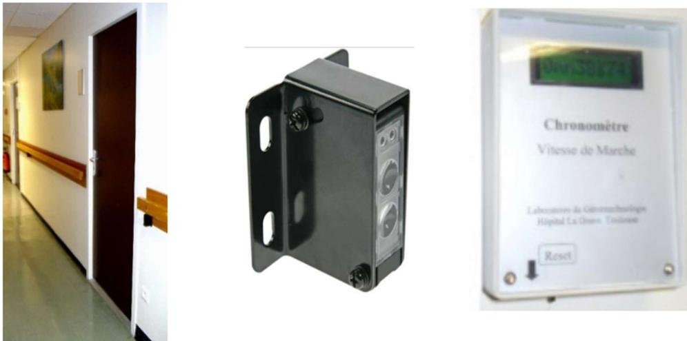
Figure 5 : dispositif de mesure de la vitesse de marche sur 4m disposé dans le couloir de consultation, de gauche à droite : vue du couloir, capteur IR actif, affichage du temps,.
