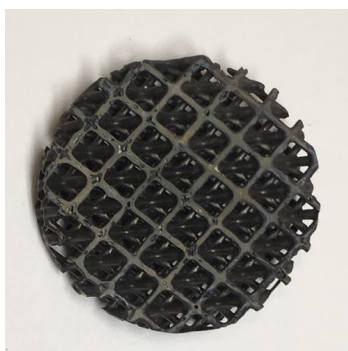
(b) Échantillon d'une mousse céramique structurée
