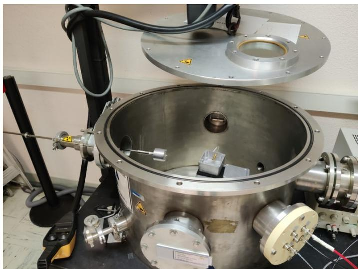
FIGURE 4.8 – Photo de la cuve CIRIL en position ouverte avec le couvercle et son hublot suspendu à un palan, en bas à droite on aperçoit sept branchements de type BNC qui permettent de faire la transition entre l'intérieur et l'extérieur de la cuve, sur le côté gauche la tige métallique porte-source au bout de laquelle une source en forme de cylindre, et enfin, en bas à gauche une soupape de dépressurisation.
