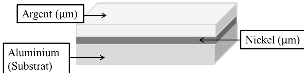
Figure 17 - Schéma d'un matériau multicouche Al/Ni/Ag
