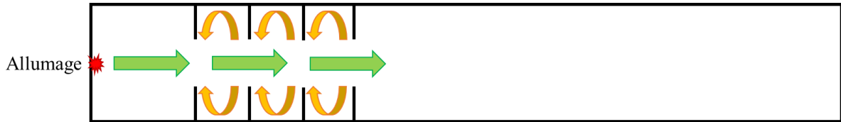
Figure 42 – Propagation d’une flamme dans un tube encombré d’obstacles.
