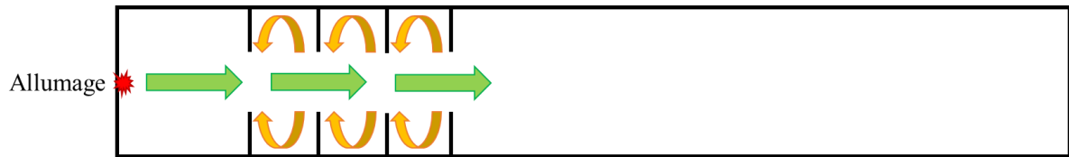
Figure 42 – Propagation d’une flamme dans un tube encombré d’obstacles.
