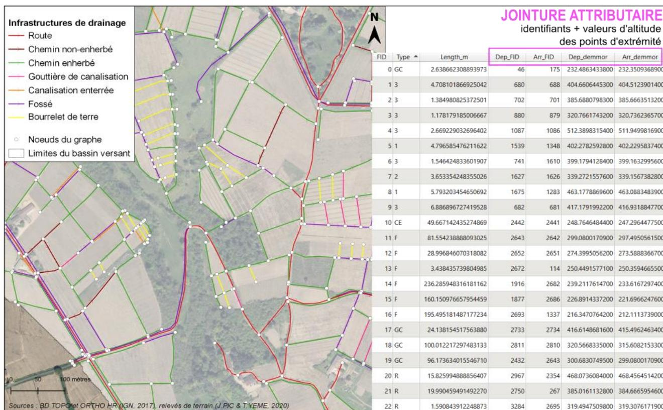
Figure 4-16 : Extrait du graphe d'infrastructures et de la table attributaire des infrastructures de drainage après jointure attributaire (sur la base des coordonnées) avec les nœuds du graphe.
