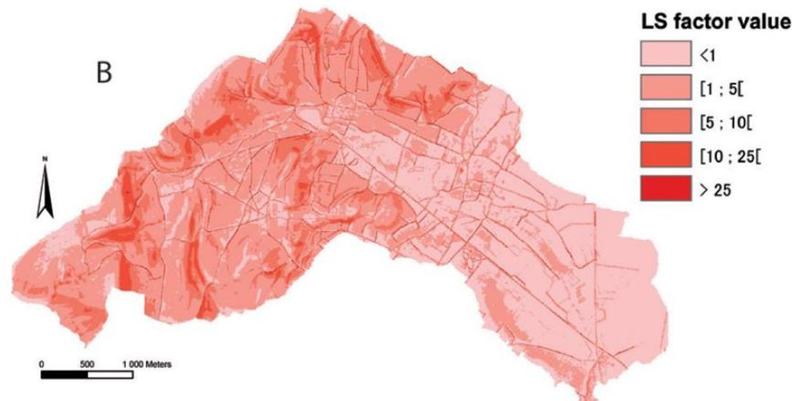
Figure 2-3 : Intégration des infrastructures de drainage dans le facteur LS du RUSLE. Source : Cossart et al (2020a).
