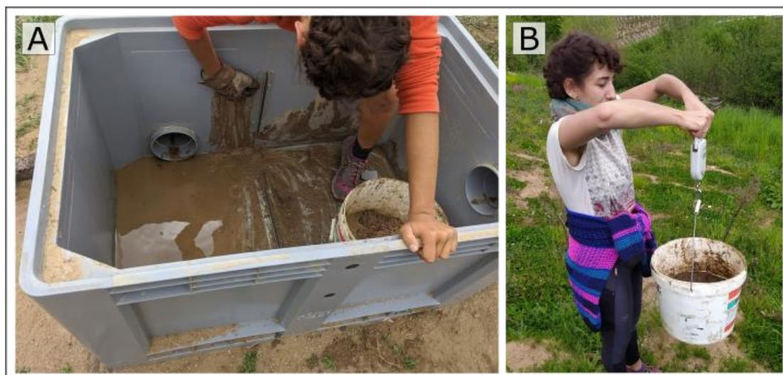
Figure 6-12 : Illustrations du protocole de mesure des sédiments grossiers. A – Curage du collecteur de sédiments. B – Pesée des sédiments collectés.
