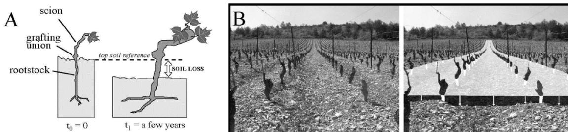
Figure 1-9 : Principe de la RUM. A – Le niveau du greffon ne bouge pas durant toute la vie de la vigne à l'inverse du cep et du système racinaire. B – Taux d'ablation estimé. Source : Brenot (2007).
