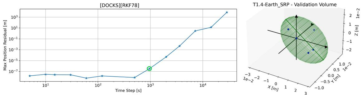
FIGURE 5.3 : Exemples de test du propagateur de DOCKS. À g. : choix du pas de temps, dans un régime d'erreur numérique non aléatoire (truncation error regime). À dr. : résiduels par comparaison avec GMAT, FreeFlyer et TUDat, après 24h de trajectoire en orbite terrestre, en considérant la pression de radiation, hors éclipses. (T. Nunes, 2024).
