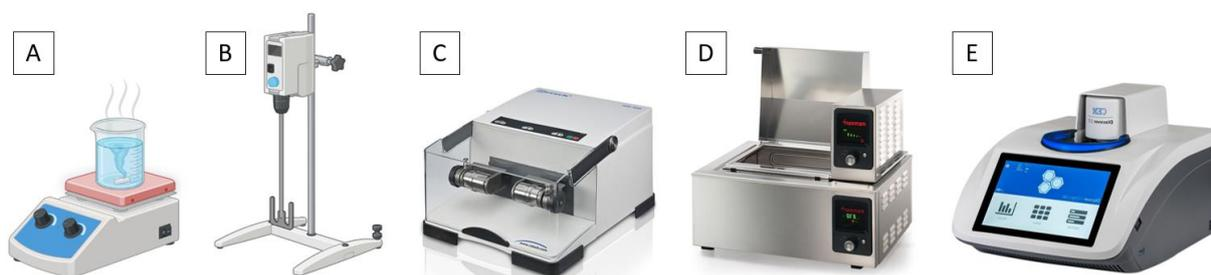
Figure VII.1 : Évolution des instruments utilisés pour la formulation des DESs : (A) bain-marie sur plaque chauffante, (B) agitateur aérien, (C) vibro-broyeur (MM 400 Retsch), (D), bain-marie thermostaté avec agitateur en translation horizontale (WNB 14/SV1422 Memmert) (E) réacteur à micro-ondes (Discover 2.0 CEM).
