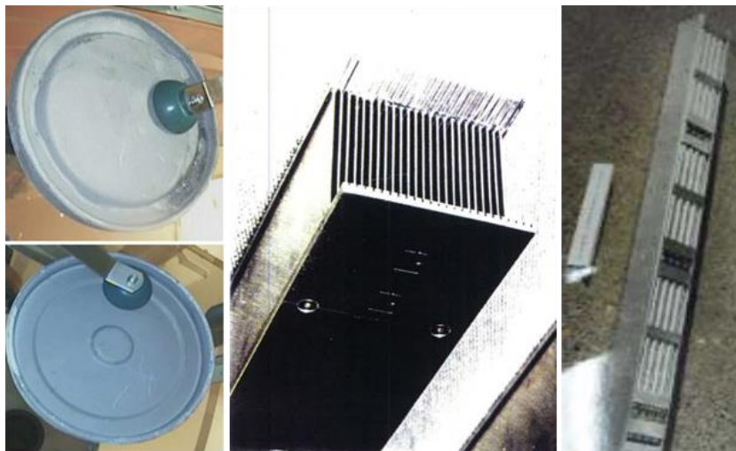
Figure I-8 : fonds et couvercles en alliages d'aluminium utilisés pour les combustibles de Chinon II et III (gauche) ; plaques de rives des combustibles de Marcoule G2 et G3 (milieu et droite) [19].
