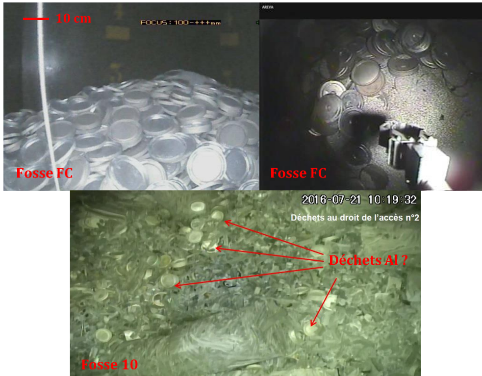
Figure I-7 : déchets en aluminium et alliages Al/Mg entreposés au CEA Marcoule [19].
