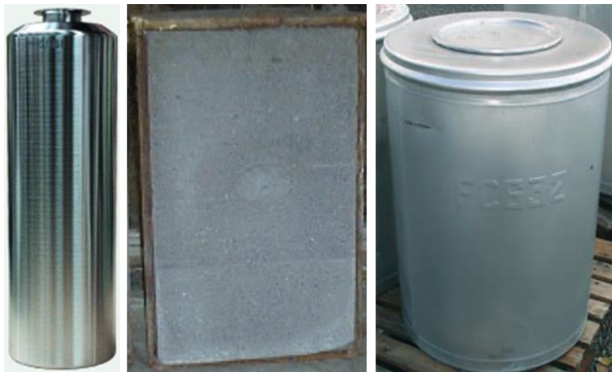
Figure I-3 : colis de déchets vitrifié (à gauche, [9]) – coupe longitudinale d'un colis cimenté (au centre, [11]) – fût de colis bitumé (à droite, [10]).
