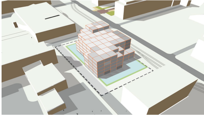
Figure 19. EcoGen : une proposition morphologique et fonctionnelle minimisant la consommation de chauffage (suite d'expérimentations lors du concours I-Factory, Lyon, la Doua, avec Pulsalys).
