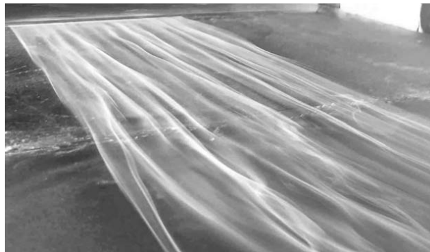
FIG. 2.4 – Visualisation par fumée de stries turbulentes obtenues dans la présente étude.
