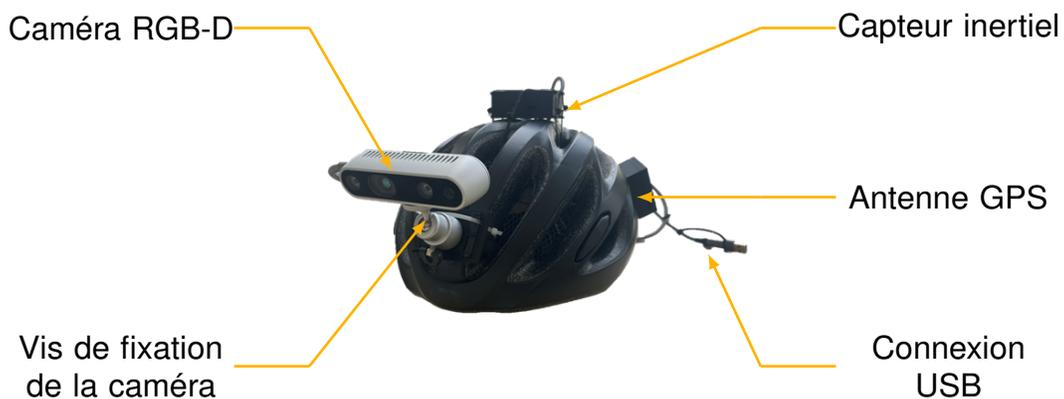
**FIGURE 5.9** – Photographie et description du système d'acquisition.
