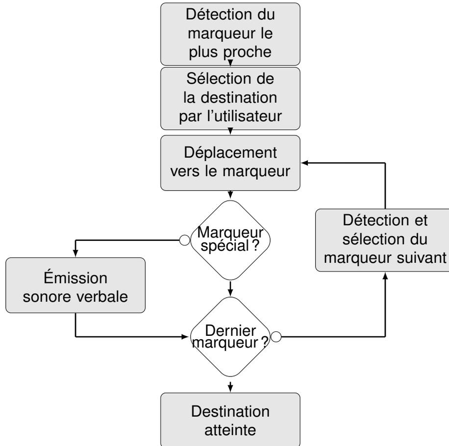
FIGURE 3.12 – Diagramme de l'algorithme de navigation intérieure.
