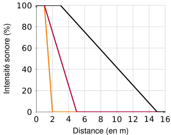
**FIGURE 5.8** – Évolution de l'intensité sonore du signal en fonction de la distance d'un obstacle. Les courbes noires et rouges représentent respectivement les obstacles dynamiques et statiques détectés. La courbe orange indique un seuil d'alerte à partir des informations de la carte de profondeur sans connaissance de la nature de l'objet.
