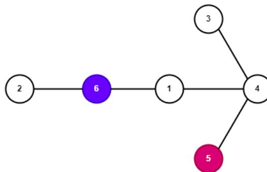
**FIGURE 3.15** – Représentation schématique sous forme de graphe de l'interconnexion des marqueurs visuels dans l'espace de navigation. Le nœud violet indique la présence d'une porte symbolisée par un marqueur spécial.
