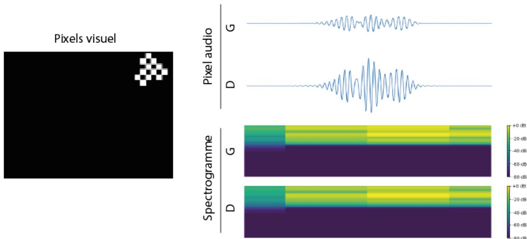
**FIGURE 3.10** – Représentation d'une information visuelle située dans le coin supérieur droit de l'image et de son interprétation sonore en termes de signal et de fréquence. Le signal sonore stéréophonique résultant de l'encodage des pixels actifs est d'une fréquence élevée avec une amplitude du signal (Position haute) du canal gauche plus élevée que le droit (Élément à droite de l'objectif).
