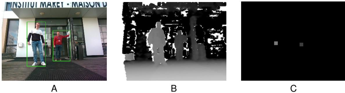
**FIGURE 4.8** – Représentation tridimensionnelle des obstacles détectés à proximité d'une personne malvoyante. **A.** Détection des obstacles environnants via un réseau de neurones dédié à la détection d'objets. **B.** Cartographie de profondeur indiquant la distance des éléments de la scène par rapport à la personne malvoyante. **C.** Modulation des centroïdes des personnes en fonction de la distance.
