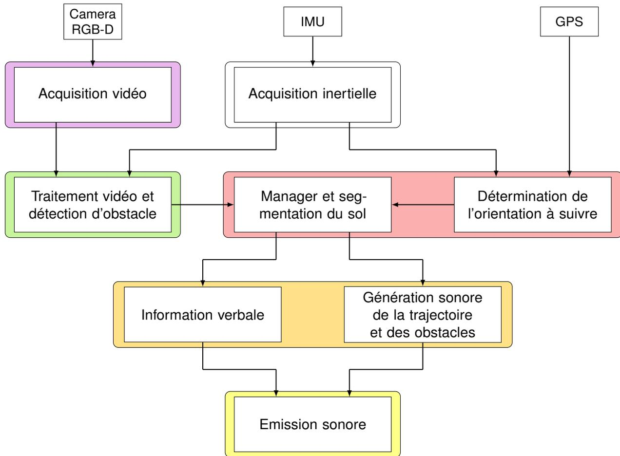
**FIGURE 5.10** – Diagramme détaillé de l'architecture du système, depuis l'acquisition des données jusqu'à l'émission sonore. Chaque ensemble de couleurs, regroupant une ou plusieurs fonctions, symbolise un processus (ou thread) dédié.
