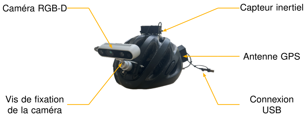
FIGURE 5.9 – Photographie et description du système d'acquisition.
