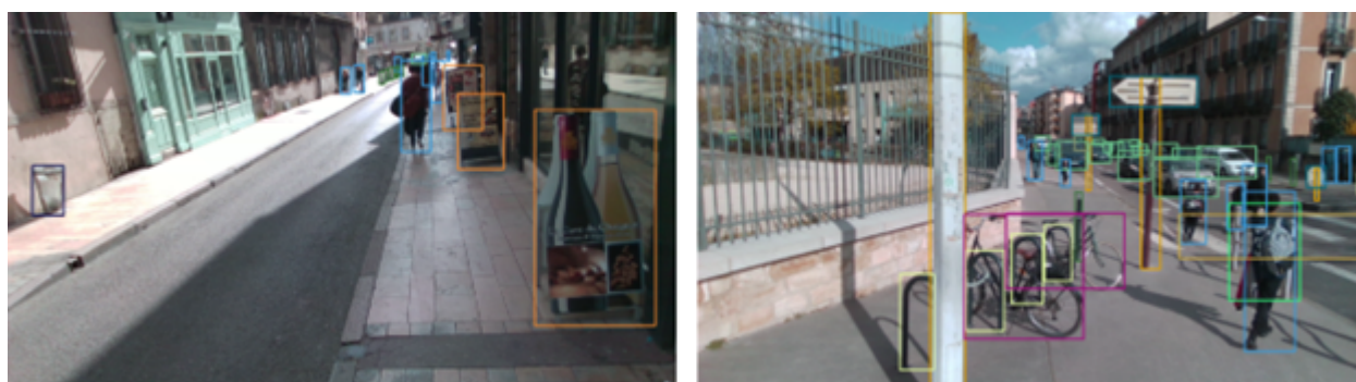
FIGURE 4.6 – Exemple de deux images issues du jeu de données annotées. Chaque classe est représentée par une couleur de boîte englobante différente.
