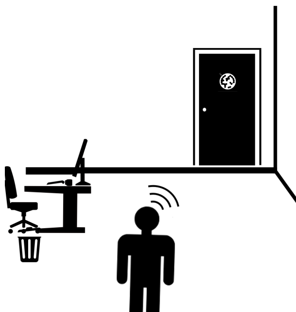
FIGURE 3.11 – Illustration d'un système de navigation sonore où l'utilisateur aveugle est guidé vers la position d'un marqueur visuel par l'émission d'un stimulus sonore.
