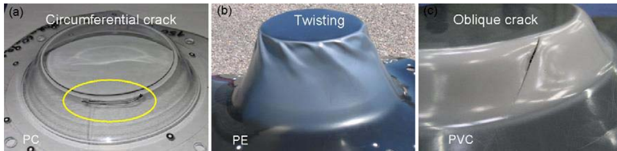
Figure I. 31 : Illustration des mécanismes de rupture et de destruction des pièces formées en SPIF [115]
