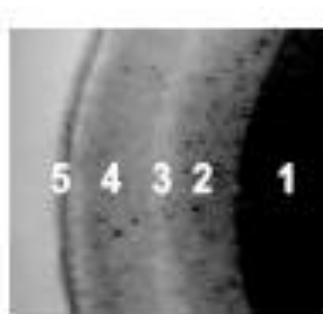
Figure I-24 : Zonage de la partie dégradée [Adenot, 1992]
