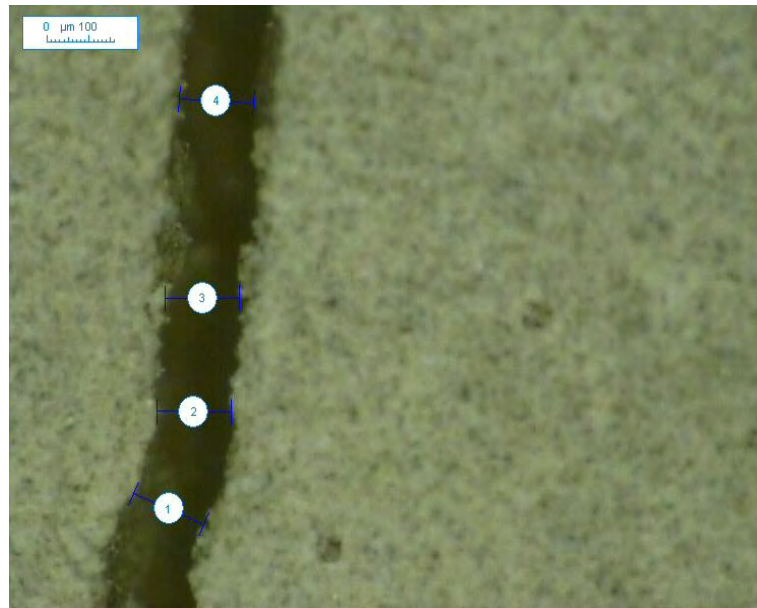
Figure III-61 : Image de la fissure sur l'éprouvette P-1 après déconfinement ( w' = 150 \mu\text{m} )
