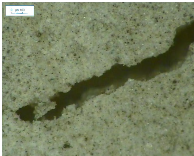
Figure III-64 : Image de la fissure sur l'éprouvette B1-2 ( w' = 150\mu\text{m} )
