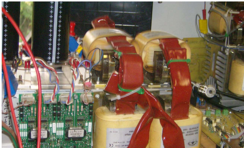
Figure.5. 2: Banc d'essai de la topologie entrelacée des convertisseurs DC/DC.
