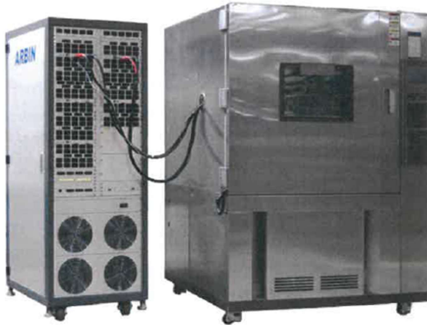
Figure.5.1: Banc de caractérisation des supercondensateurs et des batteries.
