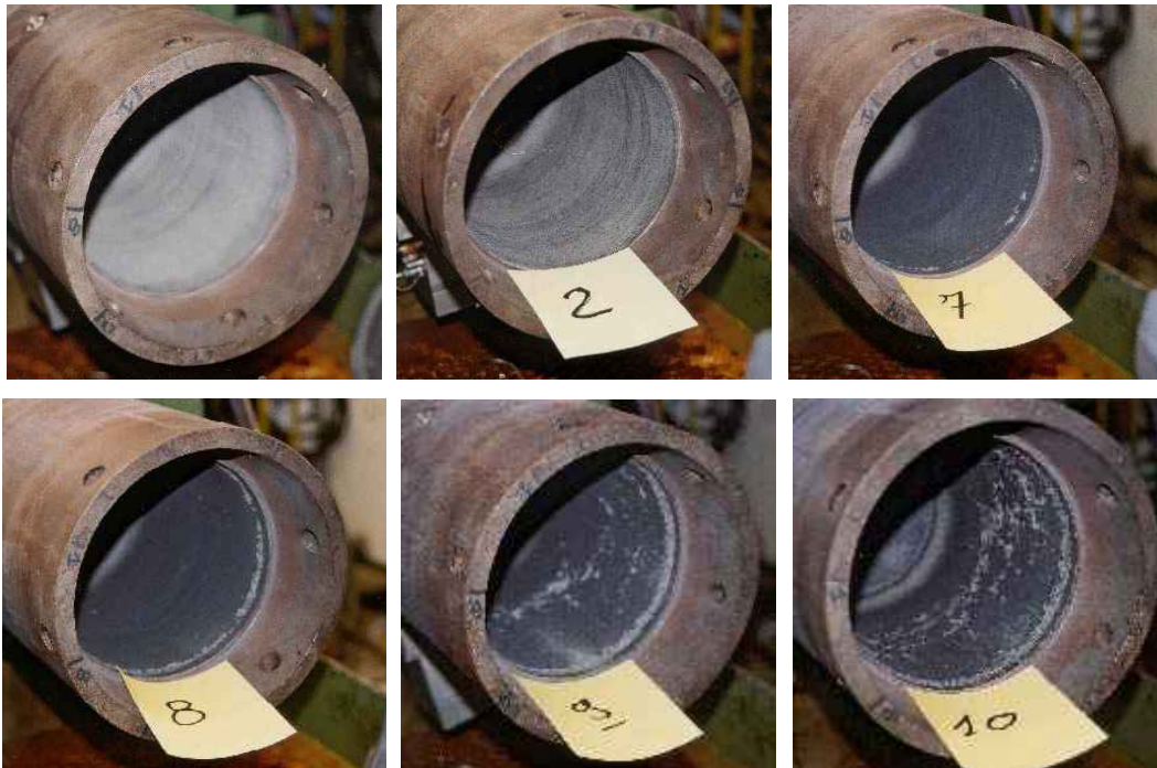
Figure 4.23. L'aspect de la surface après quelques coulées : initial et après 2, 7, 8,9 et 10 coulées [184]
