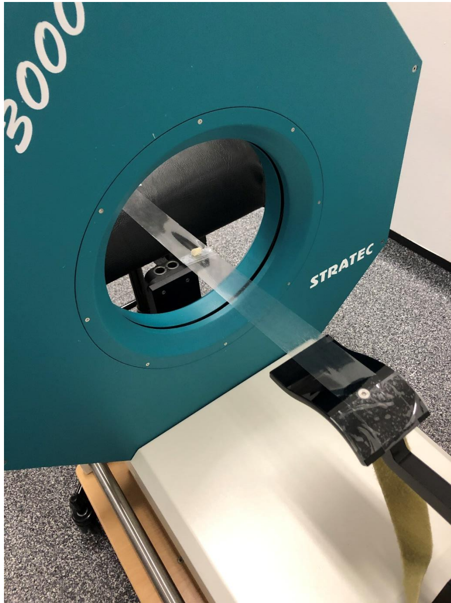
Fig. 2 : Os spongieux traité au CO 2 sc, analysé en micro-CT pQCT XCT-3000 (Stratec biomed).
