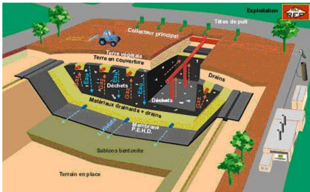
FIG. 1 – Schéma en coupe d'un casier de stockage du site de Plessis-Gassot (source Onyx/REP Energie)
