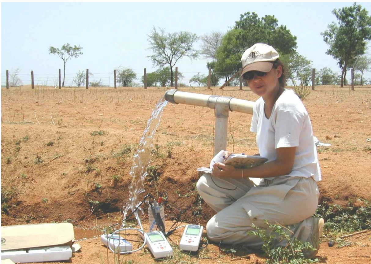
Prélèvements d'échantillons d'eau souterraine et mesures physico-chimiques in-situ dans le bassin versant de Maheshwaram (Inde, Telangana)
