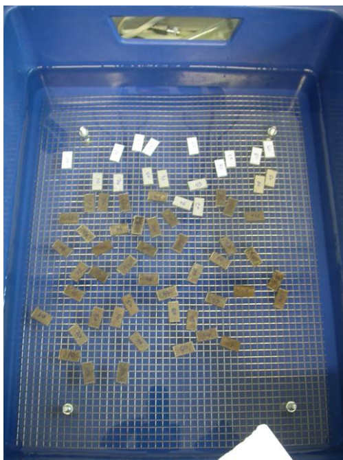
Figure V.20. Dispositif mis en place pour le test d'immersion dans l'eau pendant 24 h.
