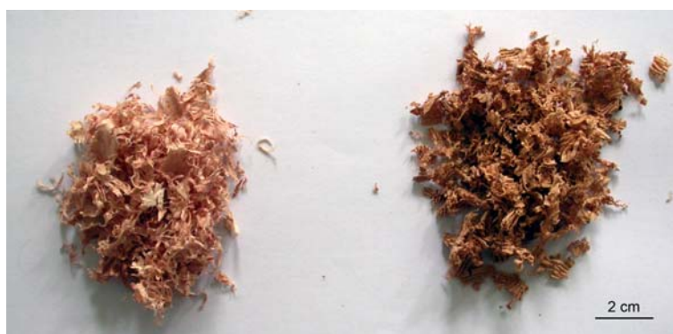
Figure V.1. Photographie des chutes de bois utilisées pour le renfort de la matrice polymère après broyage et tamisage. Eucalyptus (à gauche), curupixa (à droite).
