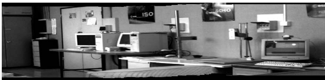
FIG. 1.3 – Une image panoramique générée simplement par collage de bandes verticales après estimation du mouvement par recherche de corrélation maximale.
