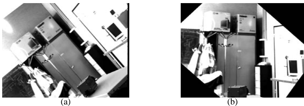
FIG. 2.1 – (a) Une image acquise par la caméra. (b) La même image après rectification en utilisant l'orientation fournie par les accéléromètres.
