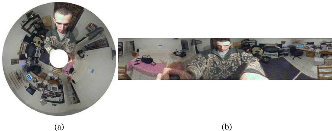
FIG. 1.15 – (a) Une image d’une caméra paracatadioptrique. (b) La reprojection de cette image sur un cylindre, représenté ici sur un plan en coordonnées cylindriques.
