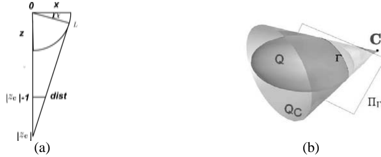
FIG. 4.25 – (a) Projection du contour d’une sphère dans l’image. (b) Projection du contour d’une quadrique dans l’image. Le plan \Pi_\Gamma est le plan polaire de C par rapport à la quadrique Q .
