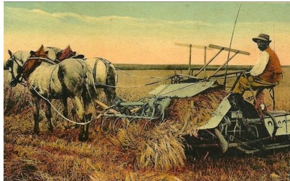
Figure 1. Modèle ancien d'une moissonneuse-lieuse tirée par deux chevaux (carte postale colorisée) (Duquennoy 2018)
