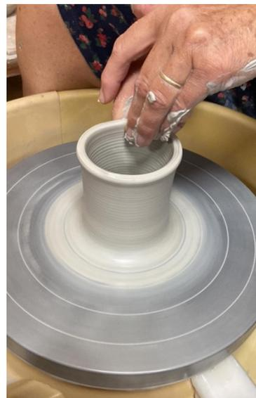
Figure 66. Ouverture du cylindre
