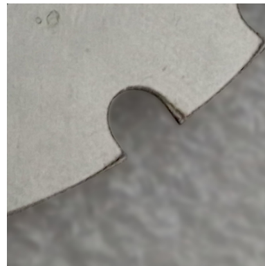
FIGURE 4.14 – Dégradation visible de la tôle autour de la découpe laser.
