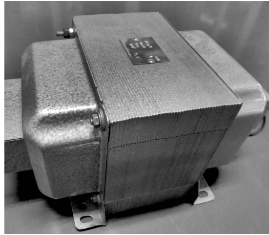
(b) Tôles assemblées dans un transformateur.
