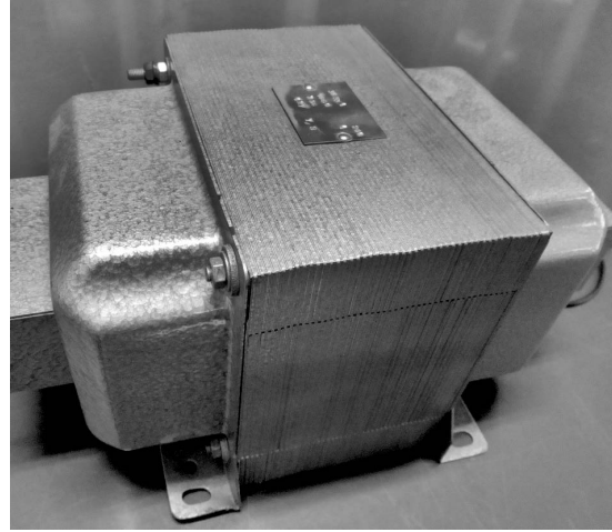
(b) Tôles assemblées dans un transformateur.
