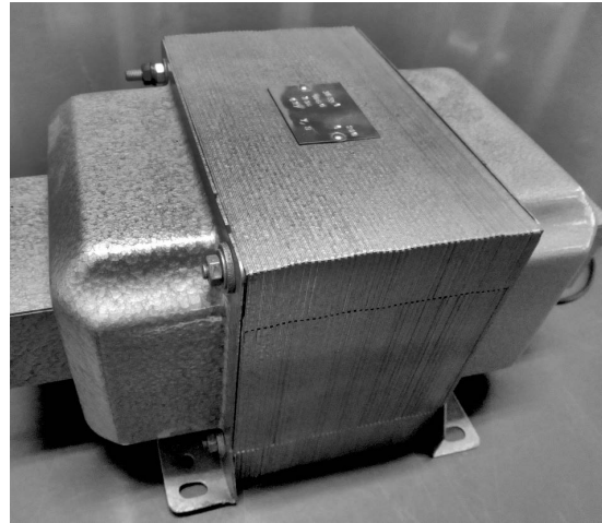
(b) Tôles assemblées dans un transformateur.
