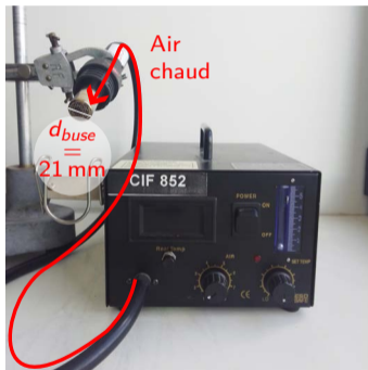
Pompe à air chaud
