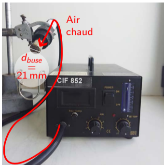
Pompe à air chaud
