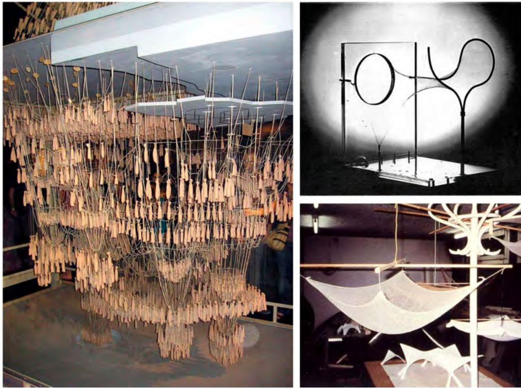
Figure 12. a. Modèle inversé de la Sagrada Família, Antonio Gaudi ; b. Bulles de savon, Frei Otto; c. Modèles de coques inversées, Heinz Isler
