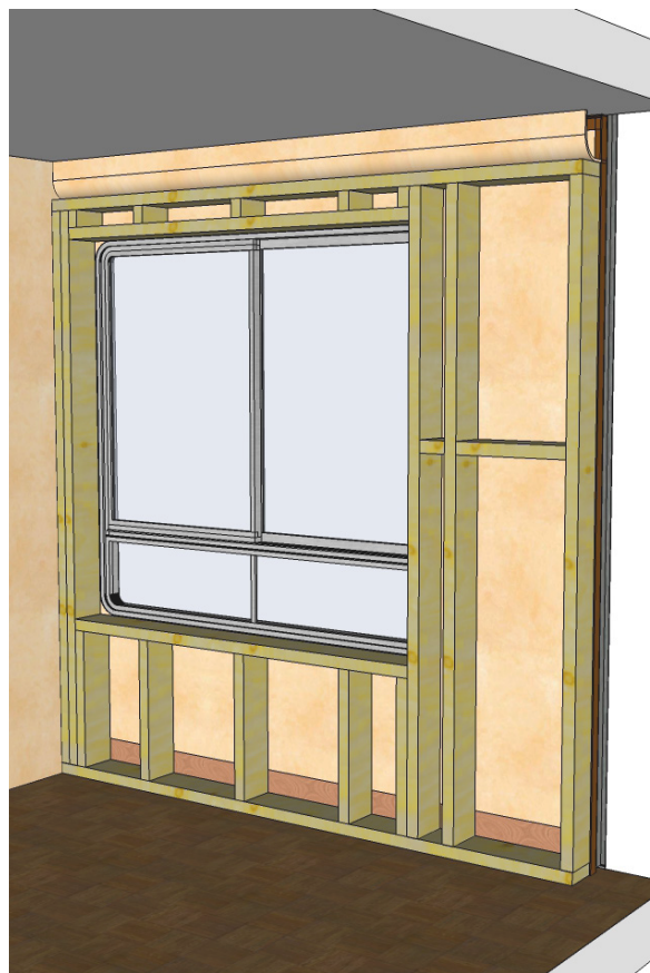
Ossature du prototype - Maquette numérique © Mathilde Padilla, archipat, 2019
