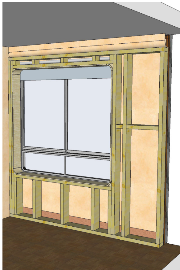
Store et précadre aux angles arrondis du prototype - Maquette numérique © Mathilde Padilla, archipat, 2019
