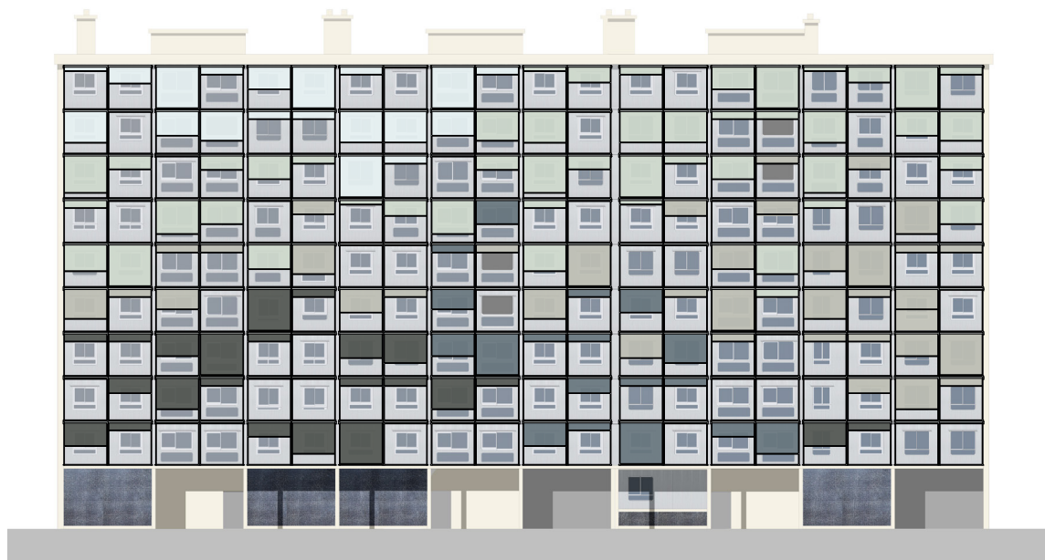
Essai de polychromie avec 5 nuances « reflets de l'aluminium » © Mathilde Padilla, azchipat
