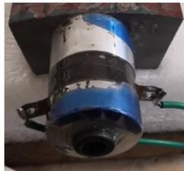
Figure 3-1 : Fixation du transducteur de l'onde pompe sur la paroi latérale de l'échantillon étudié
