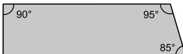
Figure 3-19: Schéma du bloc usiné pour obtenir des faces aux angles de  $85^\circ$ ,  $90^\circ$  et  $95^\circ$
