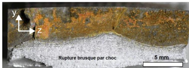
Figure 1-13: Visualisation de l'intérieur d'une fissure après son ouverture par rupture brusque de l'échantillon par choc
