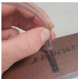
Figure 4-3: Placement du tube de refroidissement à la main
