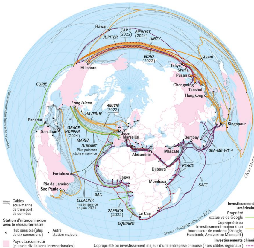
Figure 25 : Cartographie des câbles sous-marins, vecteurs de 97% des communications électroniques intercontinentales
