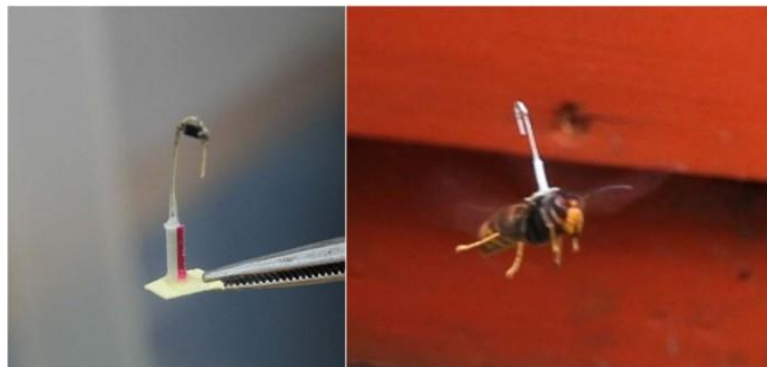
Figure 54 : Transpondeur (à gauche) positionné sur le thorax d'un frelon asiatique (à droite) à l'aide d'un petit support en papier fixé par une colle orthodontique. Cette colle se polymérise en quelques secondes à l'aide d'une lampe à lumière ultraviolette à haute intensité. L'installation dure moins de 20 secondes sans anesthésie. Certains frelons ont été observés jusqu'à 2 semaines après l'opération.[88]
