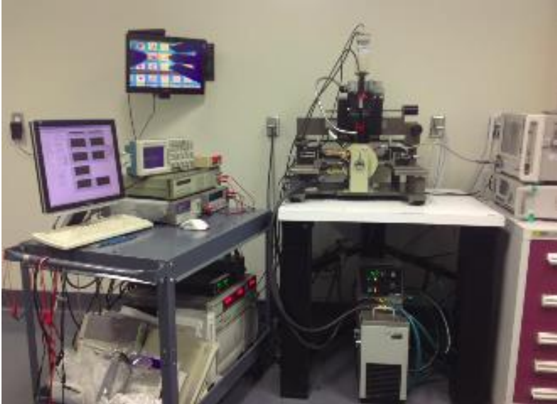
Figure 12 : Banc de caractérisation des jonctions tunnel magnétiques au sein du laboratoire PolyGrames. Les bobines de Helmholtz permettent d'appliquer un champ magnétique statique. Les pointes de test et l'analyseur de réseau permettent de faire des mesures d'impédance de DC jusqu'à 60 GHz. La source de tension et un multimètre 8.5 digits permettent de mesurer la réponse non linéaire de la courbe I(V) , la détection synchrone (lock-in amplif. SRS) permet de mesurer précisément la sensibilité de rectification du composant (en V/mW ) et une fibre optique à lentille (dont l'ombre est visible à gauche sur l'écran de télévision fixée au mur) permet de mesurer la réponse du composant à l'exposition du faisceau laser infrarouge.
